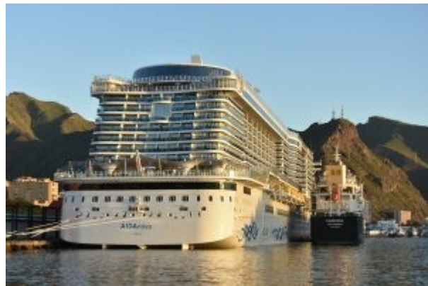
»AIDAnova« übernimmt LNG von »Cardissa« (Foto: Frank Behling)
